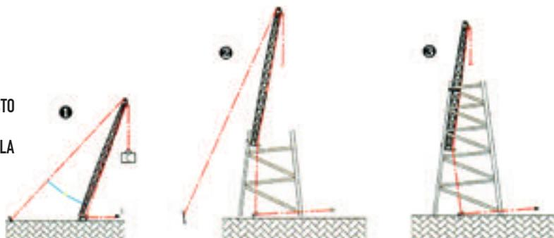
EJEMPLOS DE UN CORRECTO USO DE PLUMA DE IZADO CON PASAJE INTERNO DE LA CUERDA
