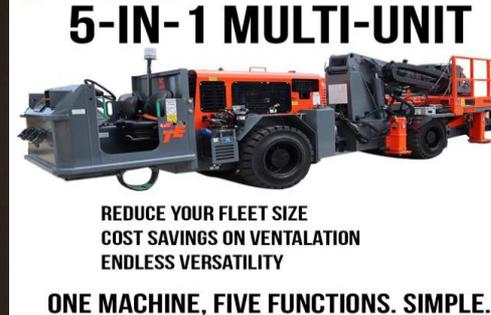
Cargador de ANFO, Las unidades explosivas se usan comúnmente en operaciones de voladura subterránea porque su carga precisa permite a los equipos de la mina romper la roca de la manera deseada. Ninguna otra unidad puede medir la velocidad, fiabilidad y seguridad de los portadores de explosivos de Timberland Equipment para la entrega y el **bombeo de emulsión altamente explosiva** o ANFO en los barrenos de voladura.
