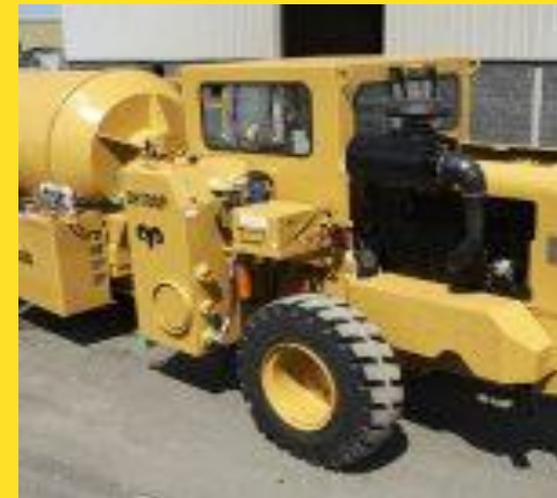
Los transportadores y rociadores húmedos de Marcotte están equipados con una pasarela segura para permitir el acceso del operador al tambor para la carga. Nuestras escotillas de tambor cubiertas de aluminio dual permiten una carga rápida de **shotcrete húmedo**.
