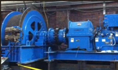
**Polipastos de 15 y 20 toneladas con clasificación de personal** Estos polipastos de 15 y 20 toneladas con clasificación de personal de 200 hp accionamientos de CA; Polipasto de manejo de materiales de uso general. Estos cabrestantes tienen una velocidad de línea de cable de trabajo de 142 fpm. Tambores individuales con ranuras de lebus y diseñados con detección de cuerda floja. Se encuentra en la ciudad de Nueva York.
